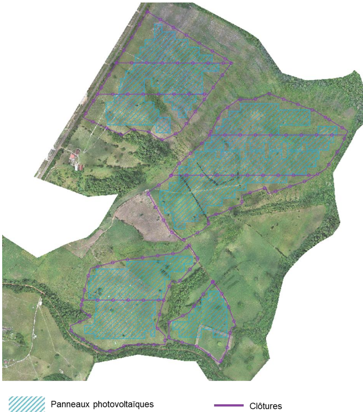
Figure 5. Plan d'implantation prévisionnel des panneaux photovoltaïques
